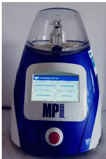
Figura 2. Omogenizator FASTPREP®-24 INSTRUMENT, utilizat pentru liza mecanică și chimică a probelor de țesut
