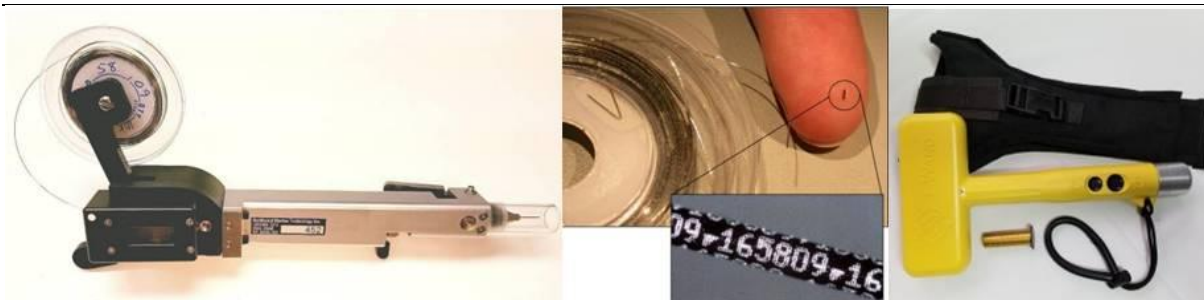
Figura 3: Injector de mărci CWT, rolă - marcă tăiată (detaliu cifre imprimate), detector mărci "T-Wand". (Sursa NMT)
